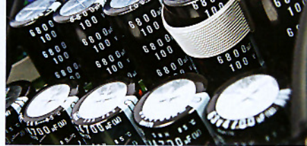
Διόλου ευκαταφρόνητα τα 78.400 μF συνολικής χωρητικότητας των πυκνωτών εξομάλυνσης στην έξοδο του τροφοδοτικού.
