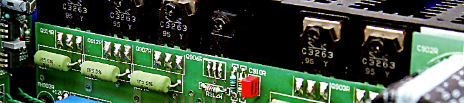
Μια εντυπωσιακή συστατική από 5 ζεύγη ημιαγωγών στο τελικό στάδιο διασφαλίζει τις υποσχέσεις του κατασκευαστή περί 300W ισχύος και άνω.
